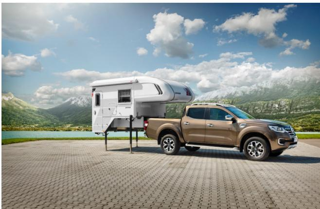
Das leichte Auf- und Absetzen von Tischer-Kabine bietet höchste Flexibilität: Sind die Stützen erfolgreich montiert, kann der Pick-up gerade unter der Kabine herausfahren.
