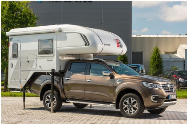
*Der Grundschrift: Die vier Stützen der Tischer-Kabine werden per Hand angebracht und ausgekurbelt.*
