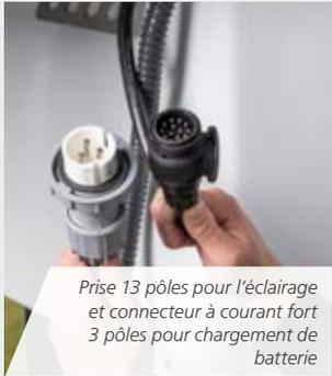
Prise 13 pôles pour l'éclairage et connecteur à courant fort 3 pôles pour chargement de batterie
