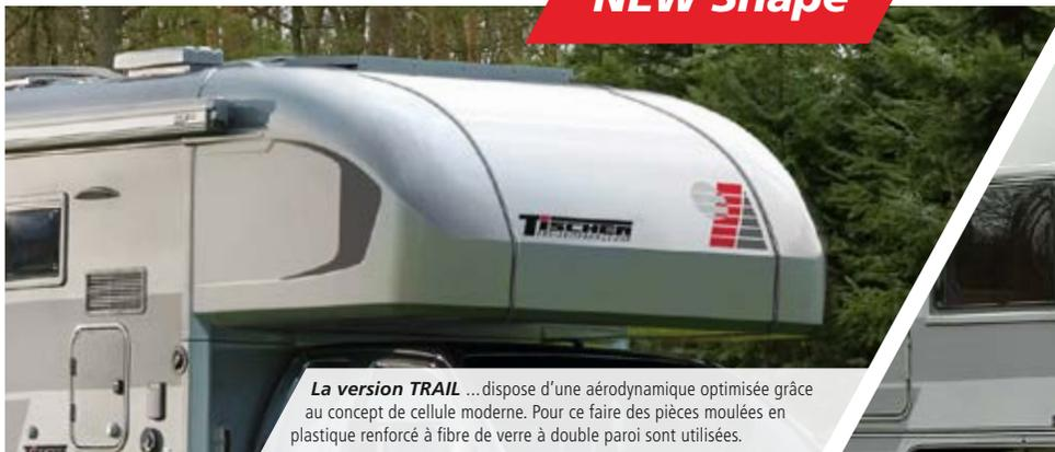
**La version TRAIL** ...dispose d'une aérodynamisme optimisée grâce au concept de cellule moderne. Pour ce faire des pièces moulées en plastique renforcé à fibre de verre à double paroi sont utilisées.
