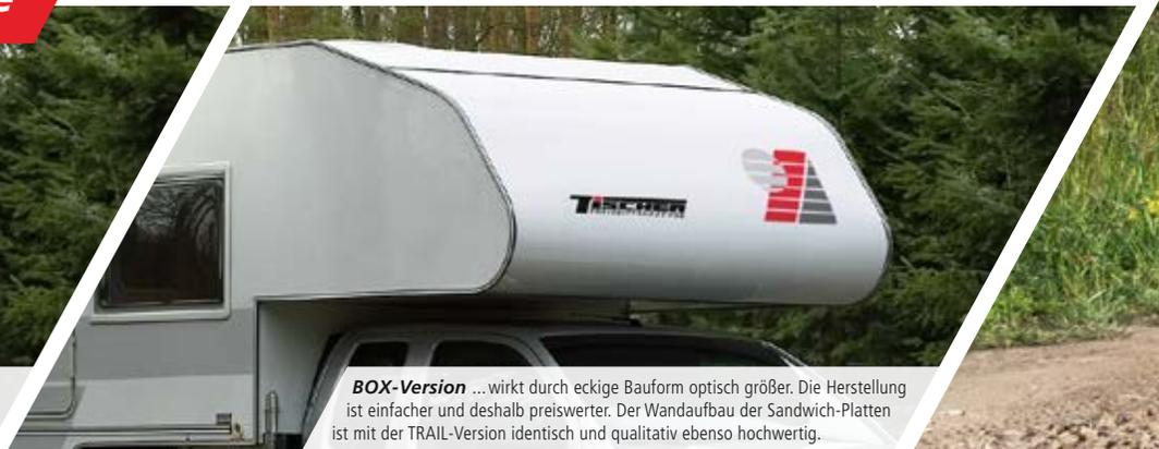
**BOX-Version** ...wirkt durch eckige Bauform optisch größer. Die Herstellung ist einfacher und deshalb preiswerter. Der Wandaufbau der Sandwich-Platten ist mit der TRAIL-Version identisch und qualitativ ebenso hochwertig.
