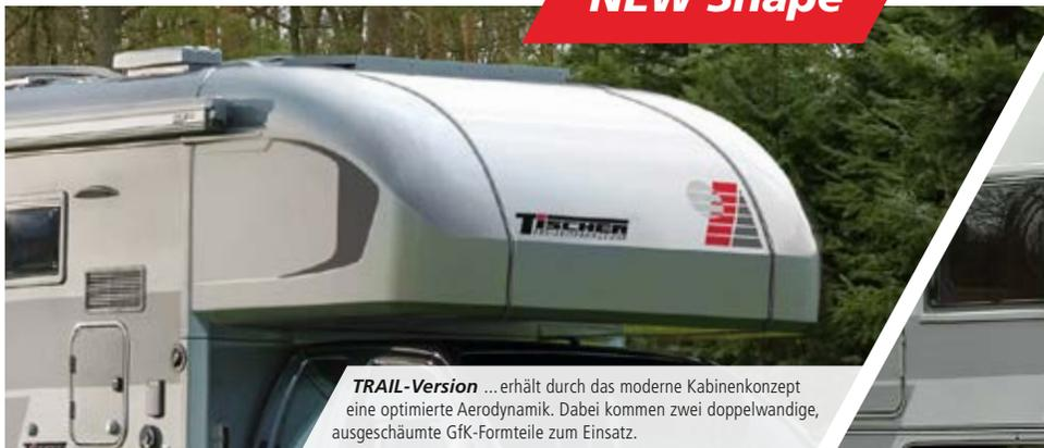
**TRAIL-Version** ...erhält durch das moderne Kabinenkonzept eine optimierte Aerodynamik. Dabei kommen zwei doppelwandige, ausgeschäumte GFK-Formteile zum Einsatz.
