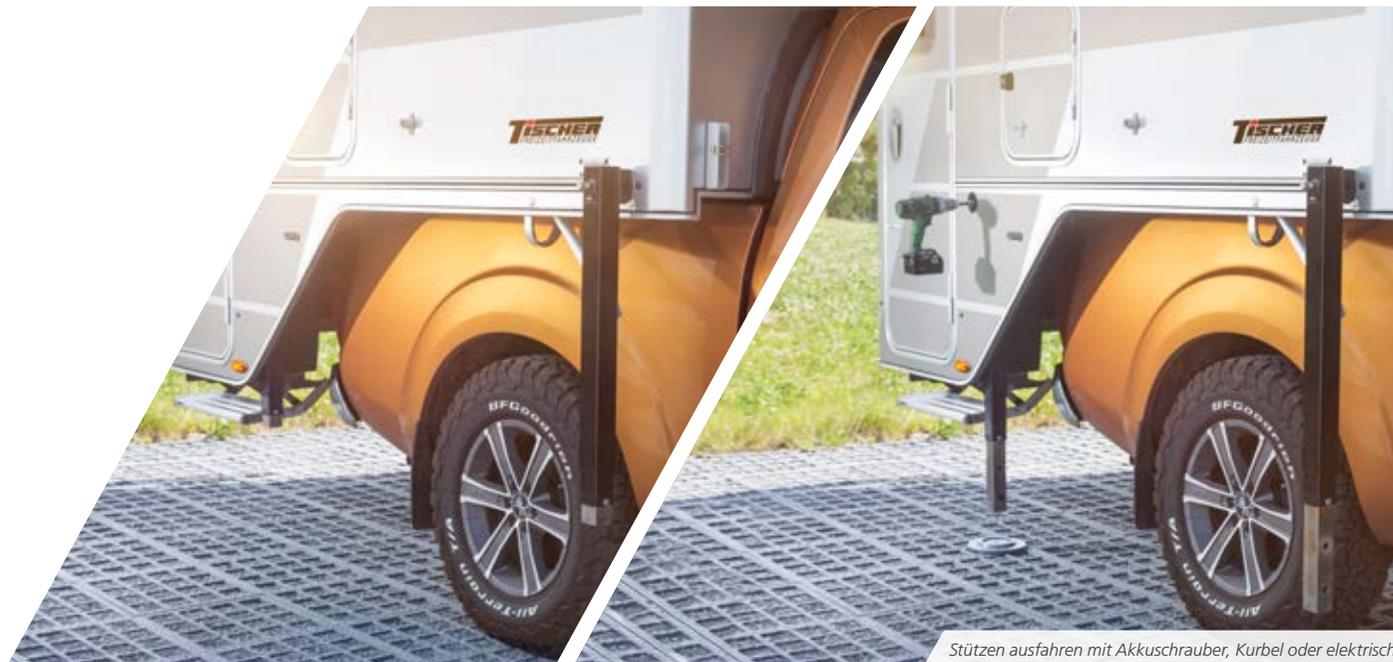
Stützen ausfahren mit Akkuschauber, Kurbel oder elektrisch
