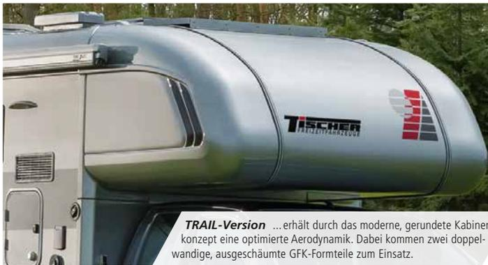
**TRAIL-Version** ...erhält durch das moderne, gerundete Kabinenkonzept eine optimierte Aerodynamik. Dabei kommen zwei doppelwandige, ausgeschäumte GFK-Formteile zum Einsatz.
