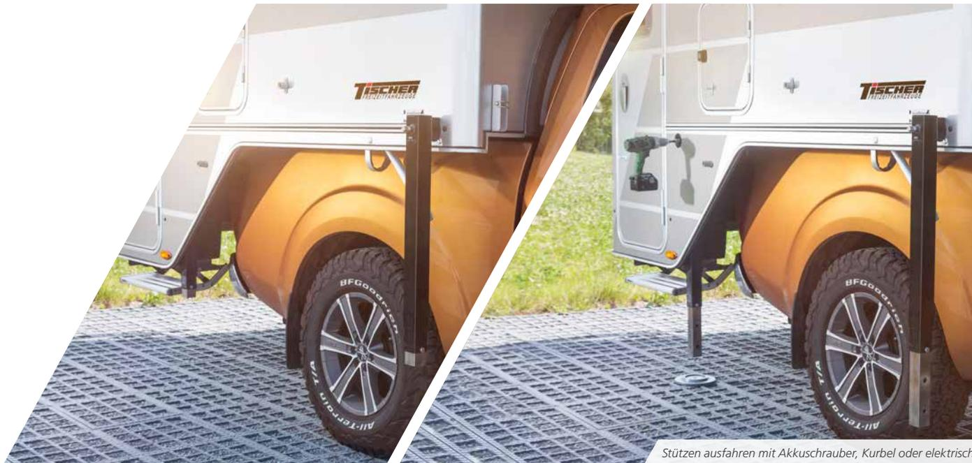
Stützen ausfahren mit Akkuschauber, Kurbel oder elektrisch
