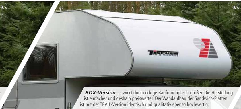
**BOX-Version** ...wirkt durch eckige Bauform optisch größer. Die Herstellung ist einfacher und deshalb preiswerter. Der Wandaufbau der Sandwich-Platten ist mit der TRAIL-Version identisch und qualitativ ebenso hochwertig.
