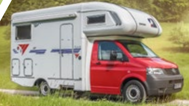
TRAIL 340S Festaufbau auf VW T5 Fahrgestell
