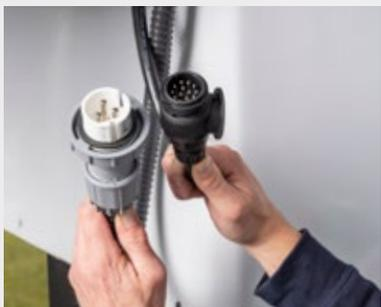
Prise 13 pôles pour l'éclairage et connecteur à courant fort 3 pôles pour chargement de batterie
