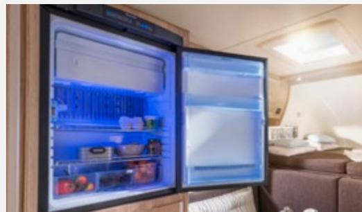
« Dometic RM8405 » réfrigérateur à absorption, 90l (12V/230V- à gaz)
