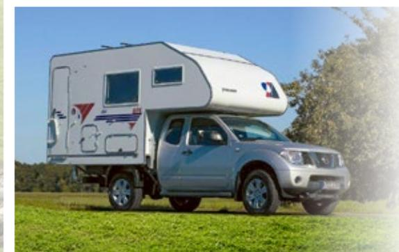
*BOX 260S, sur Nissan Navara plate-forme avec ridelles rabattables et démontables*
