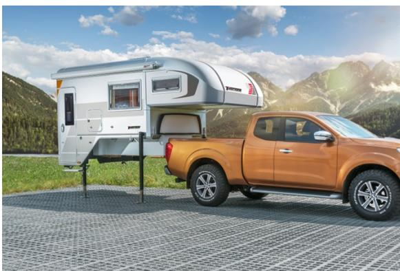
*Das leichte Auf- und Absetzen von Tischer-Kabinen bietet höchste Flexibilität: Ist die Kabine nach oben gekurbelt, kann der Pick-up gerade unter der Kabine herausfahren.*
