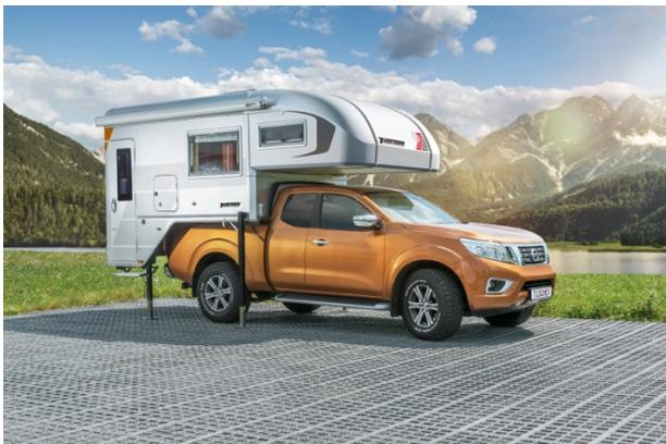
*Der Grundschrift: Die beiden vorderen Stützen der Tischer-Kabine werden per Hand angebracht und anschließend alle vier Stützen nacheinander ausgekurbelt.*
