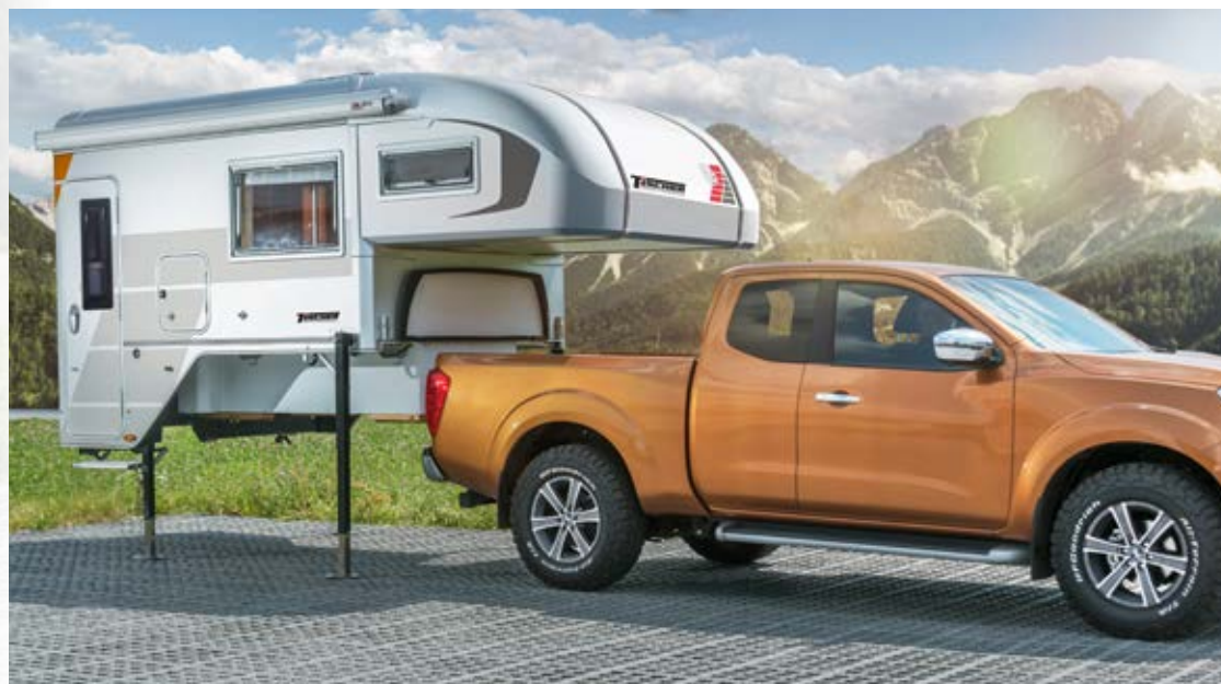
Stützen ausfahren mit Akkuschauber oder Kurbel
