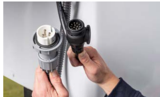
13-poliger Stecker für Beleuchtung und 3-poliger Hochstromstecker für Batterieladung
