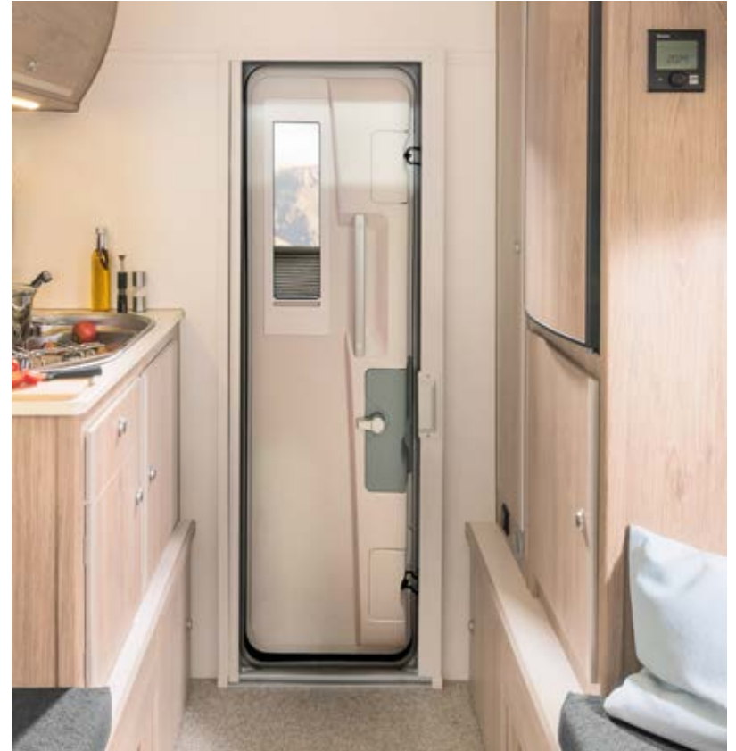
Eingangstür mit Doppelverriegelung
