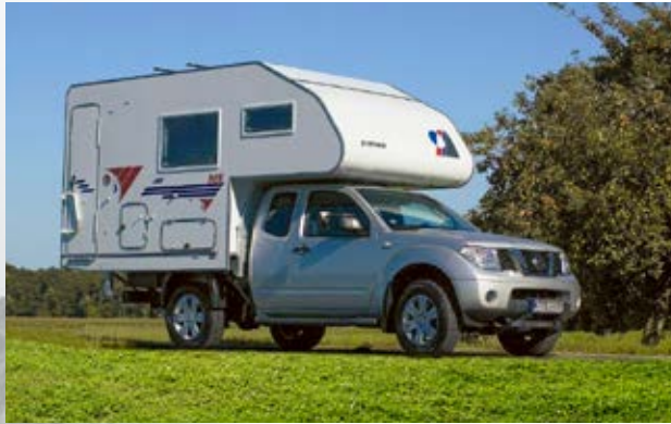
Tischer Box 260S auf Nissan Navara – Plattform-Pritsche mit klappbaren, demontierbaren Bordwänden
