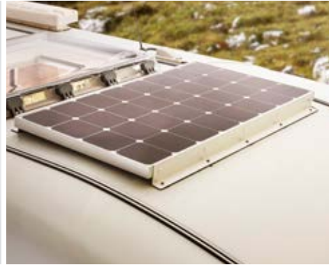
110 Watt-Solaranlage, Ladestromregler (Standardausstattung: 1 x 110 Watt-Solarpanel)
