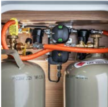
„TRUMA Duo Control CS“ Gasregler-Anlage
