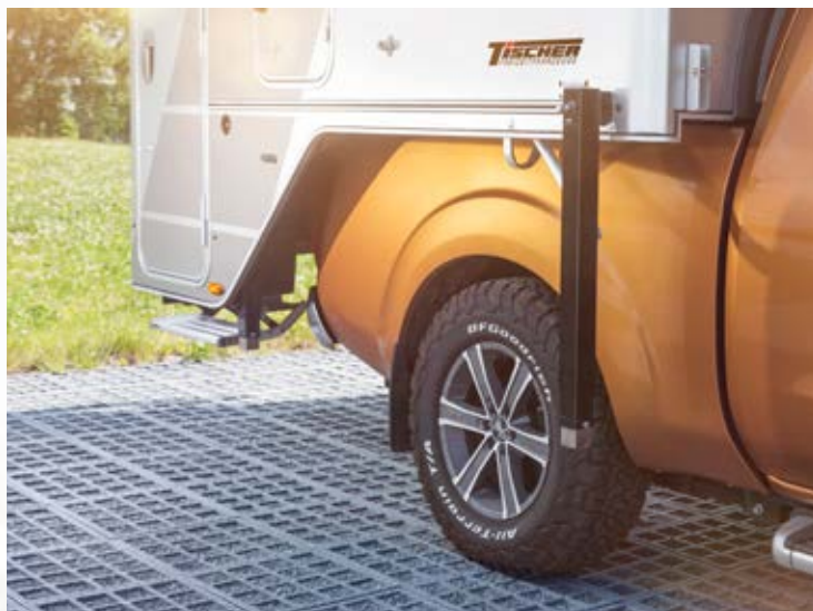
Stützen ausfahren mit Akkuschauber oder Kurbel
