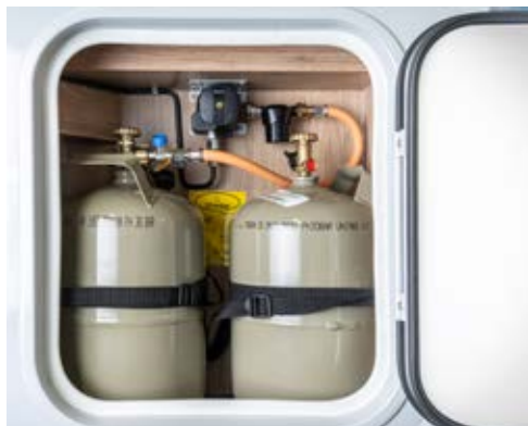
„TRUMA Mono Control CS“ Gasregler-Anlage
