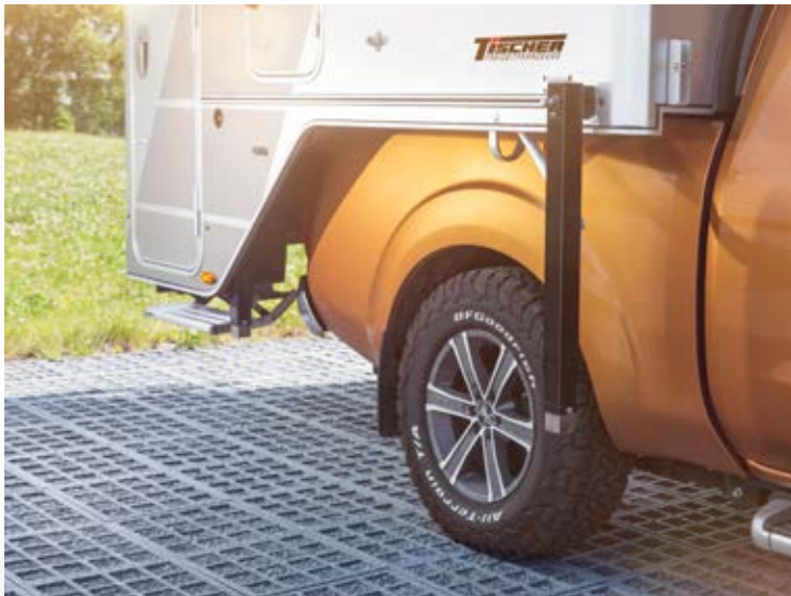
Stützen ausfahren mit Akkuschauber oder Kurbel
