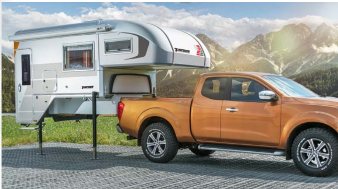
Stützen ausfahren mit Akkuschauber oder Kurbel
