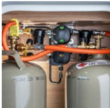
„TRUMA Duo Control CS“ Gasregler-Anlage
